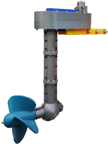
Fig. 6. Sistema de Propulsión - Imagen del prototipo construido
