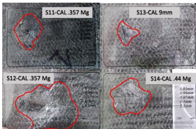
Figura 40: Orificios de salida de los proyectiles calibres .357 Mg, 9 mm y .44 Mg en la especie FKPU1.
