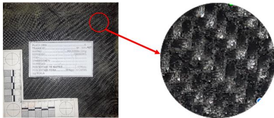
Figura 15: Placa reforzada con fibra de carbono (HM).
