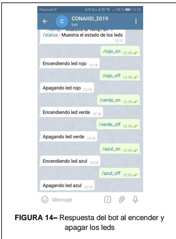
**FIGURA 14– Respuesta del bot al encender y apagar los leds**
