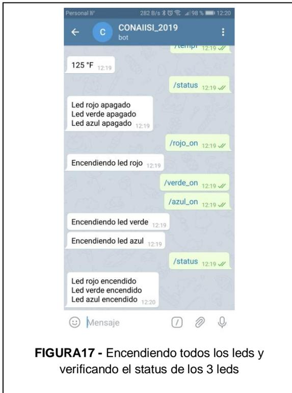
**FIGURA17** - Encendiendo todos los leds y verificando el status de los 3 leds
